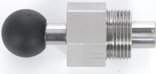
VENTILMAX-SMART Einschraubwerkzeug aus Edelstahl massiv mit Kugelknopf aus Thermoplast. Für Heizkörperventile DN 15 (1/2") mit Innennocken-Ventilnippel. Mit Verschraubungs-Aussengewinde 3/4" für Heizkörperventil-Überwurfmutter und mit Aufnahmebolzen. Mit aussen angeordneter Sechskantaufnahme SW 30.
