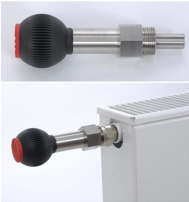
VENTILMAX-TOP Einschraubwerkzeug aus Edelstahl massiv mit Handgriff aus Thermoplast. Für Heizkörperventile DN 15 (1/2") mit Innennocken-Ventilnippel. Mit Verschraubungs-Aussengewinde 3/4" für Heizkörperventil-Überwurfmutter und mit extra langen Aufnahmebolzen. Mit aussen angeordneter Sechskantaufnahme SW 30.
